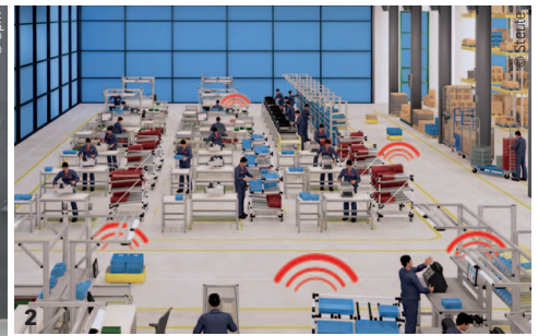
1 Die FTF für die E-Fahrzeugmontage eignen sich unter anderem für die reine Fließfertigung. Bei einigen Typen können die Werker während der Montage auf dem Fahrzeug mitfahren. 2 Ein Funknetzwerk kann gleich mehrere Aufgaben übernehmen – zum Beispiel die Kommunikation mit einer FTF-Flotte und die Nachschubversorgung per E-Kanban.
