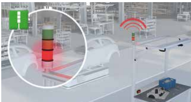
Das Funksystem kann parallel auch weitere Aufgaben übernehmen, zum Beispiel die Integration von Andon-Systemen
