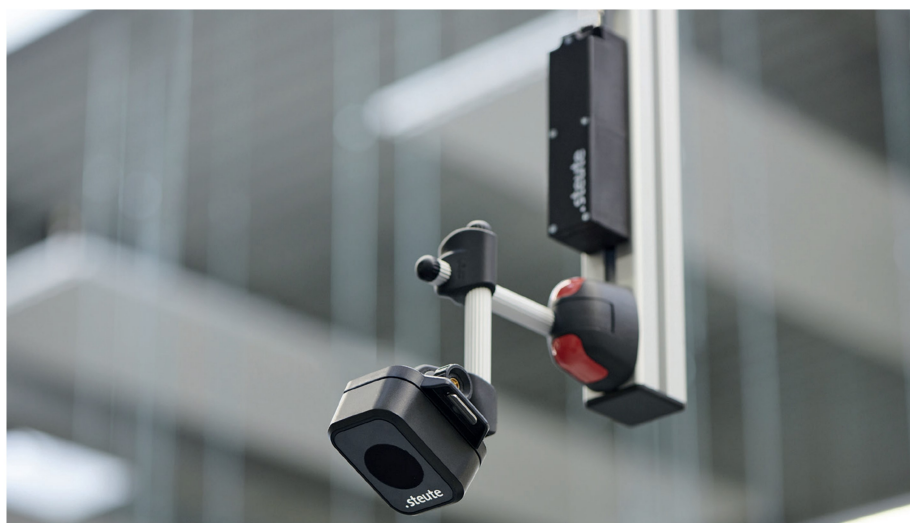
Bild 2: Erfassung von oben: Funklasersensoren können den Bestand von Palettenware erfassen oder auch den Füllstand in Großladungsträgern
