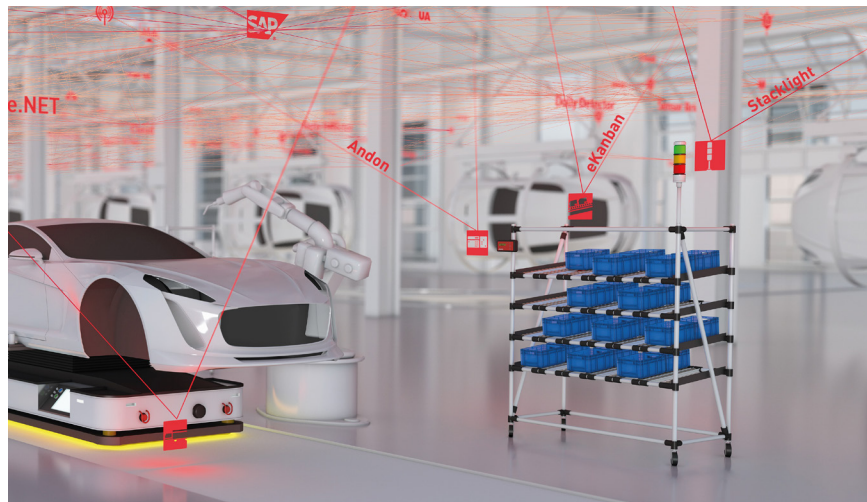
Für E-Kanban-Anwendungen: Funksensoren erfassen Behälter in Durchlaufregalen und senden die Signale über eine Sensor Bridge an das ERP, LVS oder PPS.
