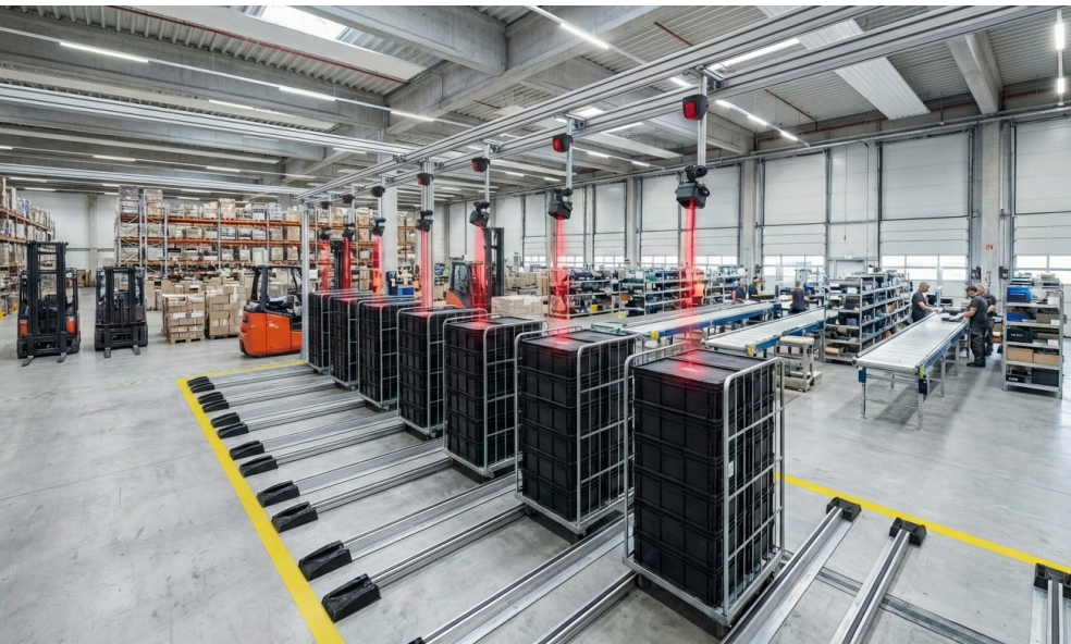
nexy-Funksensoren ,zählen' Dollys in Kom- missionierbahnhöfen.
