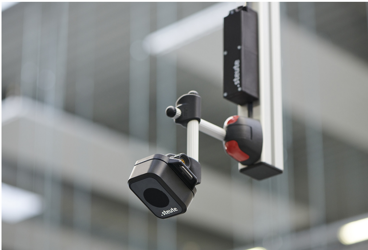
Bestandteil der Nachschubsteuerung: Lasersensoren erfassen zum Beispiel den Bestand von Palettenware oder palettierten Behältern.
