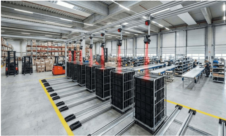
I sensori wireless nexy “contano” i carrelli nelle stazioni di commissionamento.
