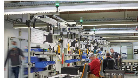
Ortsunabhängige Ansteuerung von Signal- säulen via Funk / Location-independent remote management of stack lights
