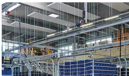
Berührungslose Erfassung von Großladungs- trägern auf Stellplätzen / Non-contact monitoring of holding areas for large load carriers
